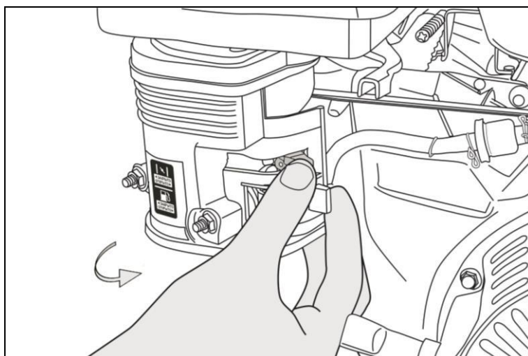
Рис.16. Воздушная заслонка закрыта
